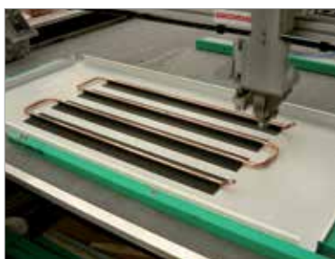
Montagem em fábrica das placas radiantes metálicas
